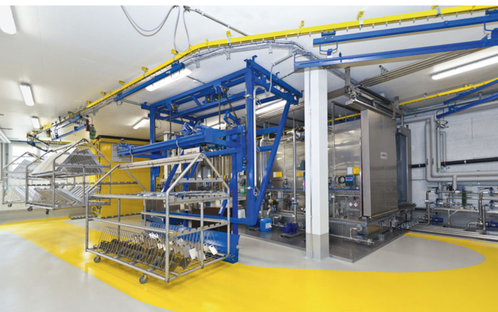
Die hochmoderne, umweltschonende und voll automatisierte Waschanlage bereitet Teile aller Art zur Nachbearbeitung vor.
